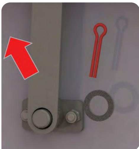
Anschließend können die Verbindungsarme gelöst und zur Seite in die Stufe geschoben werden.
