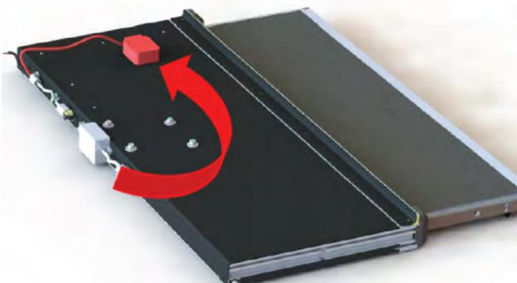
Vor der Montage am Fahrzeug sollte das Steuengerät auf die Oberseite der Trittstufe verlegt werden!
