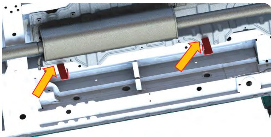
Anschließend die hinteren Halter 2905L & 2905R mit der Karosse verschrauben.
