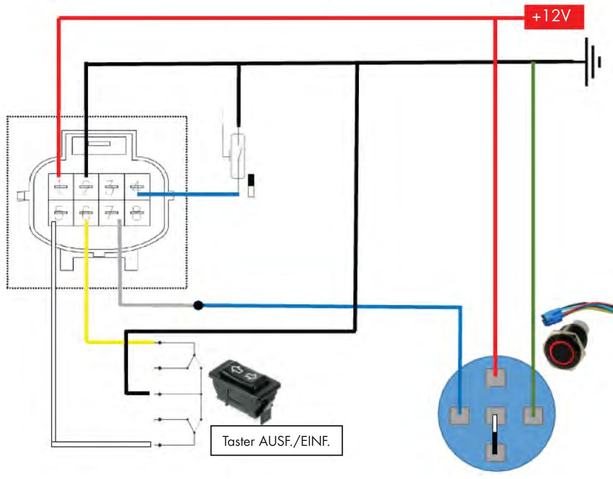
Wenn die Schiebetür geöffnet ist, muss Masse geschaltet werden (Öffner).
