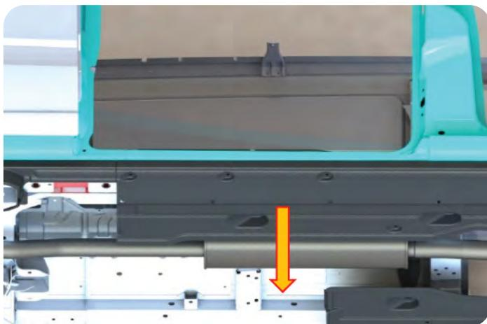
Vor der Montage muss die Kunststoffverkleidung im Bereich der Stufenmontage vorsichtig demontiert werden. Weiterhin muss aufgrund der Stufenmontage bestimmte Bereiche der Kunststoffverkleidung ausgeschnitten werden.
