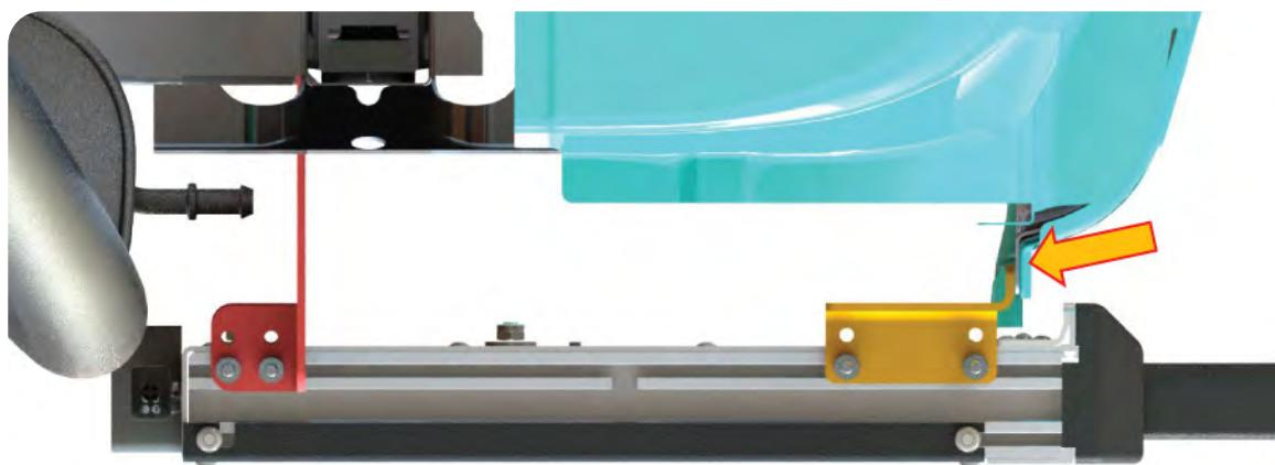
Für die Befestigung der vorderen Halter, die Position der Bohrungen am Schweller anzeichnen und mit einem Bohrer **Ø6,5 mm** durchbohren. 2 x 6,5 mm Bohrungen an jedem Halter.
