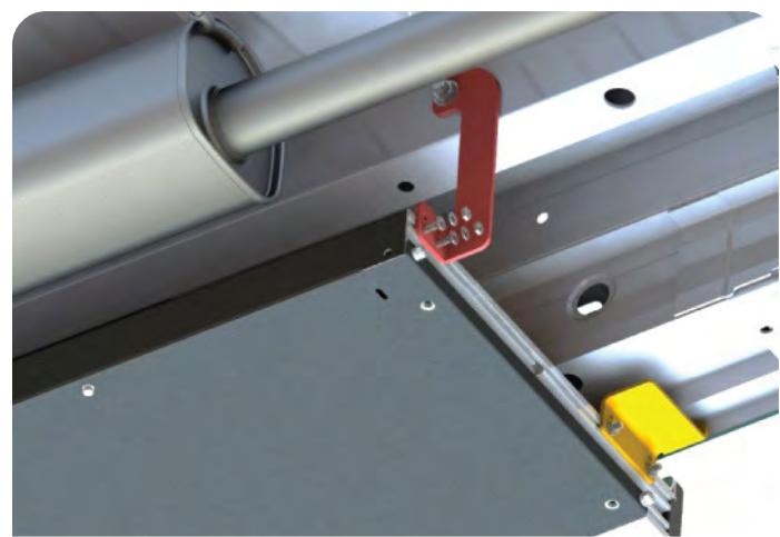
Anschließend die Stufe ausrichten. Die vorderen Halter sollten bündig am Schweller ausgerichtet werden. **Die Stufe sollte aufgrund des Platzverhältnisses so weit wie möglich nach außen, weg von der Hitzequelle montiert werden.** Dies ist aufgrund der flexiblen Montageschiene an der Stufe möglich.
