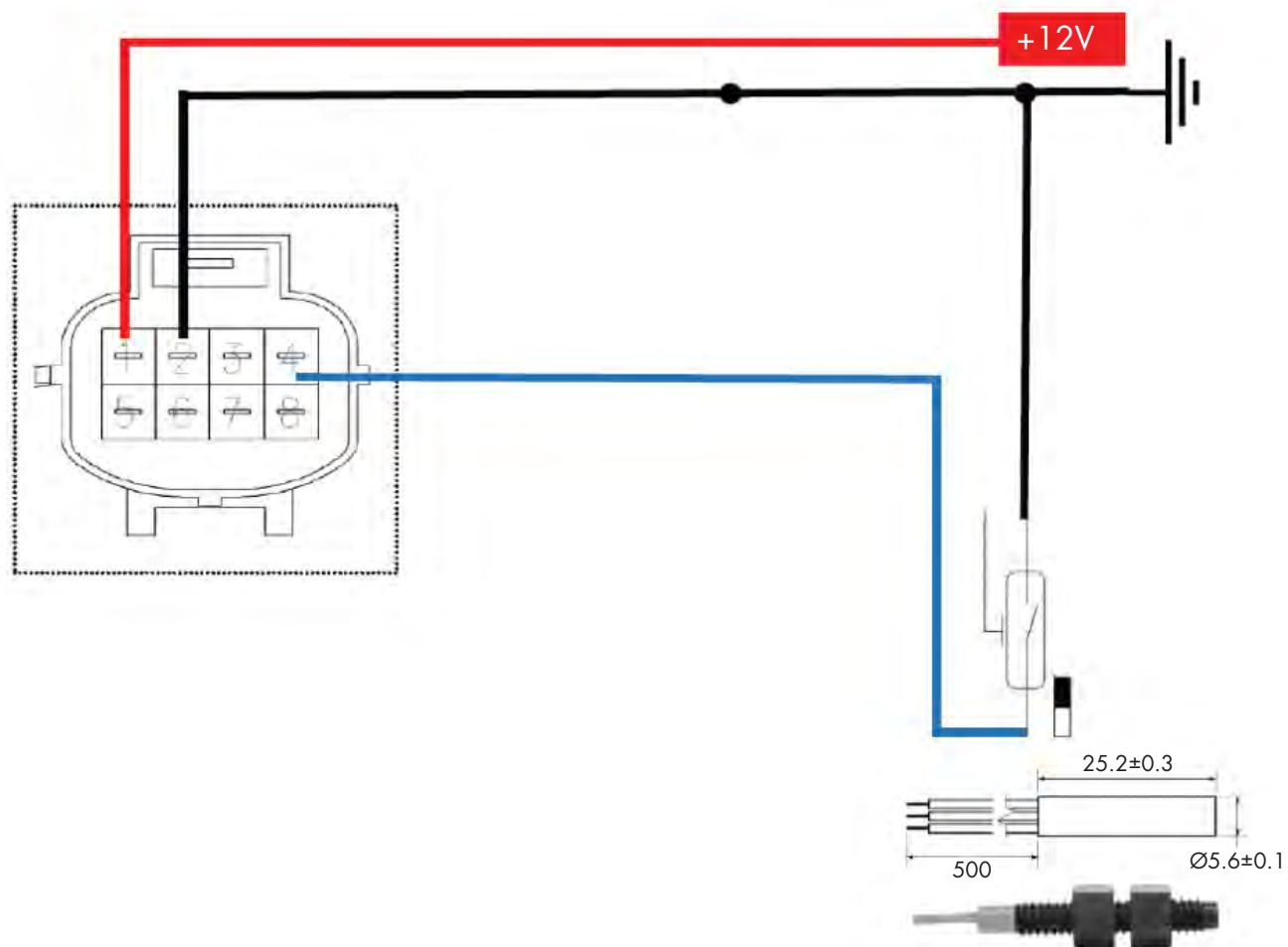
Der Magnetschalter ist ein Wechsler. Die elektrische Verbindung sollte durch einen Fachbetrieb je nach Einbausituation vorgenommen werden. Elektrische Verbindungselemente sind daher nicht im Lieferumfang enthalten.
