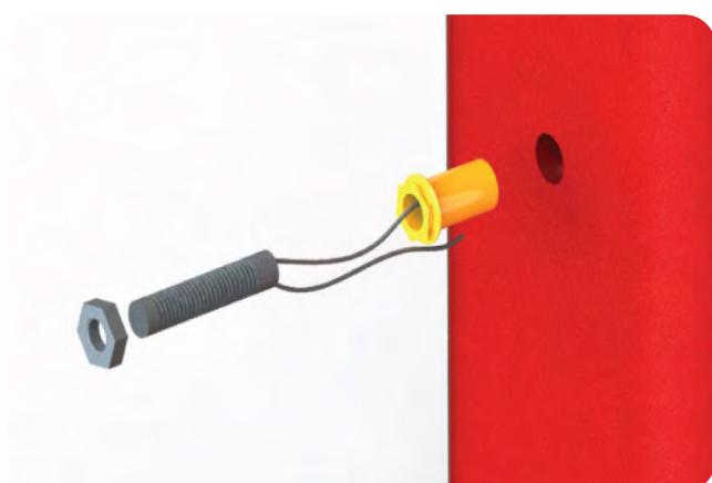
Die Einziehmutter sollte so positioniert werden, dass dieser konzentrisch zum Magneten steht. Anschließend eine Bohrung Ø11,1mm vornehmen und das Bohrloch anschließend versiegeln.
