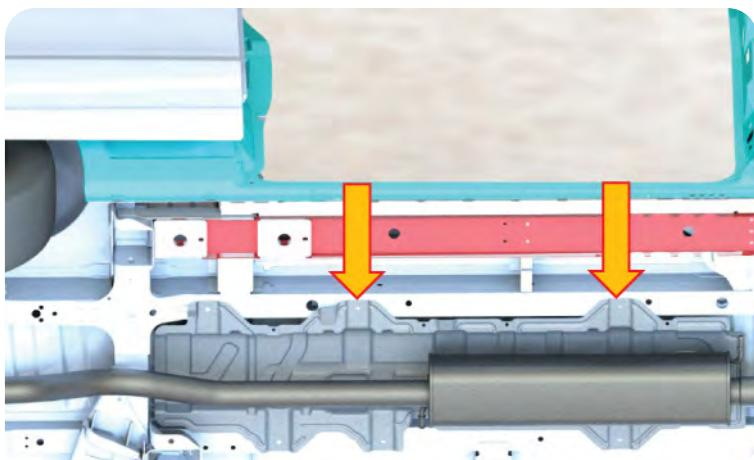
Die montierte Trittstufe muss ggfs. mit Hitzeblechen vor der heißen Abgasanlage geschützt werden. Hier müssen hitzeschützende Maßnahmen durch zusätzliche Hitzebleche erfolgen. Hier kann im Schadensfall keine Garantieansprüche erhoben werden.
